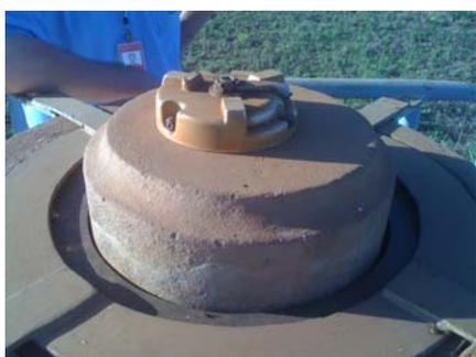
El monitoreo de alta precisión geodésica es el único que mide los desplazamientos absolutos, verticales y horizontales de la represa de ITAIPU, mediante un sistema de procesamiento de datos específicos para la red de observaciones implementada en la ITAIPU.
